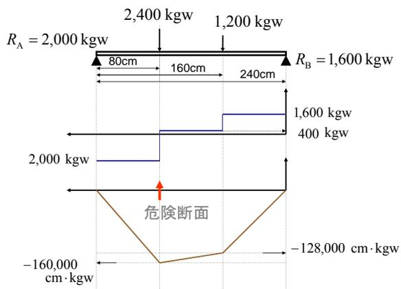
図のようなはりの断面係数はいくらあればよいか。最大の縁(ふち)応力の値を  $\sigma_b = 800 \text{ kgw/cm}^2$  とする。
