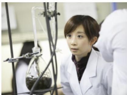
ハッカ精油は医薬品扱いのため薬局方のとった器具、方法で蒸留します。ゆっくり1時間かけて採った精油はハンドクリーム作りの実習にも使えます。
