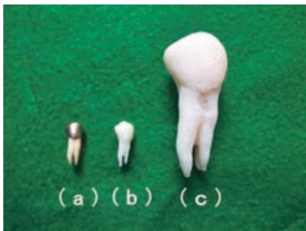
図2 3Dプリンターにより造形された歯牙模型(a: 実際の歯, b: 等倍模型, c: 拡大模型)
